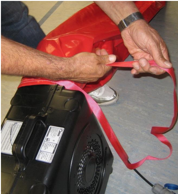
Den hinteren „Rüssel“ an den Kompressor anschließen
